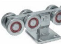
Профессиональная, 8-роликовая опора с цельной плитой и усиленными герметичными подшипниками со специальной низкотемпературной смазкой (до -60°C).
