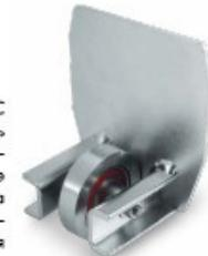
Конструкция ролика концевого МАКС обеспечивает абсолютную надежность крепления в направляющей. Рекомендуется устанавливать ролики концевые совместно с ловителями нижними на оба торца направляющей. Для тяжелых откатных ворот не рекомендуется использовать заглушки, не оснащенные роликом и ловителем нижним.
