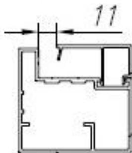
**Алюминиевый профиль штапика** имеет глянцевую структуру поверхности и будет поставлять в следующих стандартных цветах: RAL9016 белый (глянец), RAL8014, RAL8017 коричневый (глянец), RAL3004 красный рубин (глянец), RAL5010 синий (глянец), RAL6005 зеленый мох (глянец), RAL9006 серебристый металлик (глянец).
